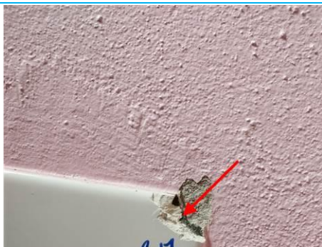
Matériaux : ZPSO-045 Prélèvement : P045 Description : Colle/faïence Localisation : IME – 1 er étage - Pièce 42 Résultat : Présence d'amiante
